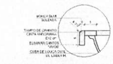
5 DETALHE 1 - SAIA DE GRANITO DA PIA ESCALA 1:5
