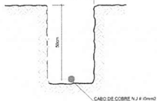
1 VALA PARA CABOS DE ATERRAMENTO SEM ESCALA
